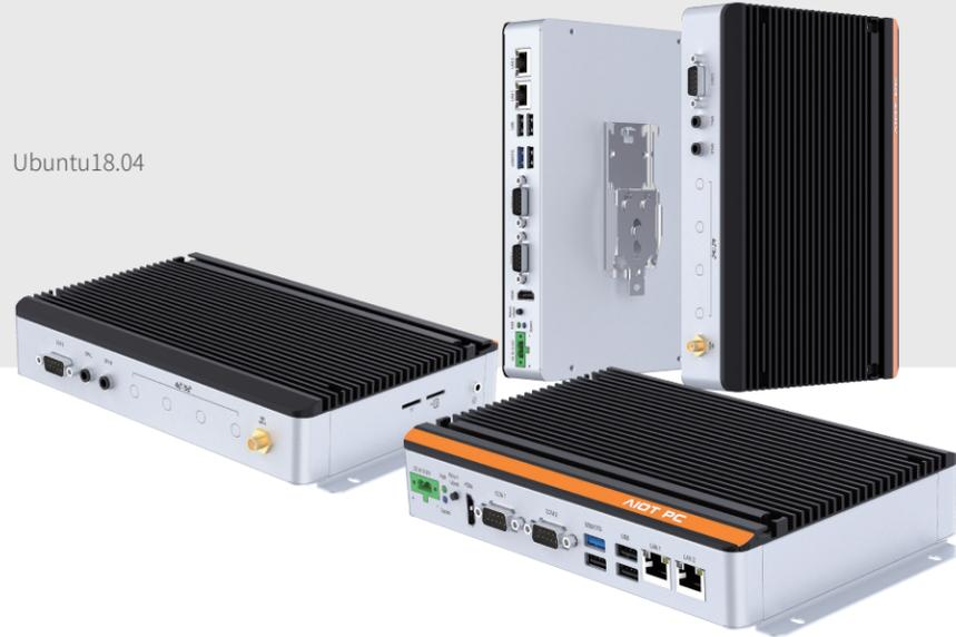
eBOX-390X-3399, 采用Rockchip RK3399 6核高性能处理器, 满足AI智能、智慧应用、算力需要。双千兆以太网、支持4G/5G、WiFi网络, 4路串口, 4路USB, 接口丰富; 支持支架、导轨安装; 可广泛用于工业网关、人脸识别设备、瘦客户机(云端服务)、VOIP视频会议系统、IoT物联网领域、VR录像、VR等行业。
