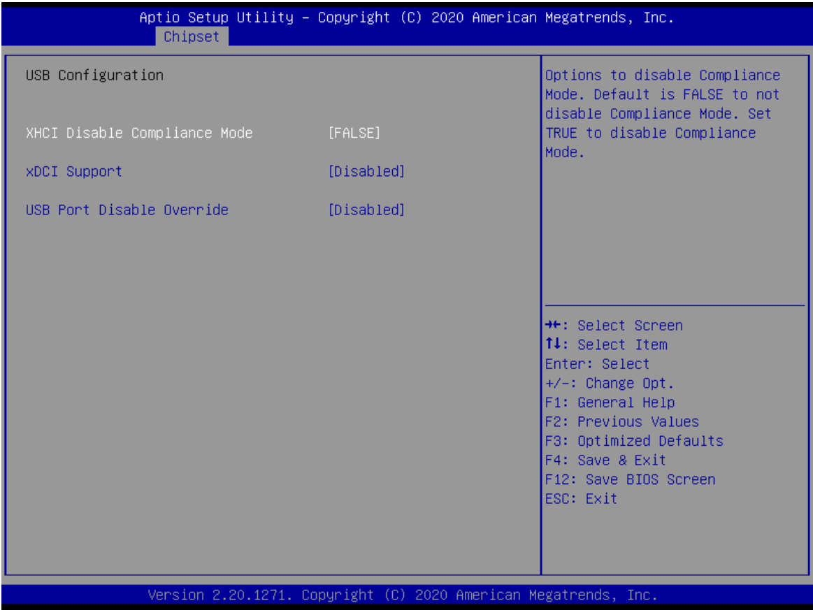
图 3-21 NP-6122 BIOS-USB Configuration
