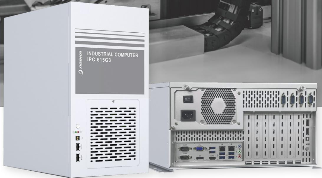
IPC-615G3是一款专为工业应用打造的紧凑型小4U机箱，基于高性能的Intel® Core™ i3/i5/i7/i9和Pentium®、Celeron® 台式机处理器。具备出色的数据处理能力，能够高效应对各种边缘计算任务。同时，可安装标准ATX主板并支持标准4U电源，确保系统在各种工作条件下都能稳定运行。该产品最多支持7槽位全高卡扩展，满足多种行业应用的需求。
