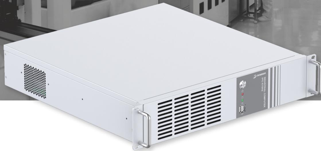
IPC-615H2是一款标准的19英寸2U上架式机箱,符合行业标准,方便集成到各种工业环境中。它基于高性能的Intel® Core™ i3/i5/i7/i9和Pentium®、Celeron®台式机处理器。具备出色的数据处理能力,能够高效应对各种边缘计算任务。同时,可安装标准ATX主板确保了系统的稳定性和可靠性。扩展性方面,它最多支持7槽位半高卡扩展,适应多行业应用需求,如数据采集、视频监控等。
