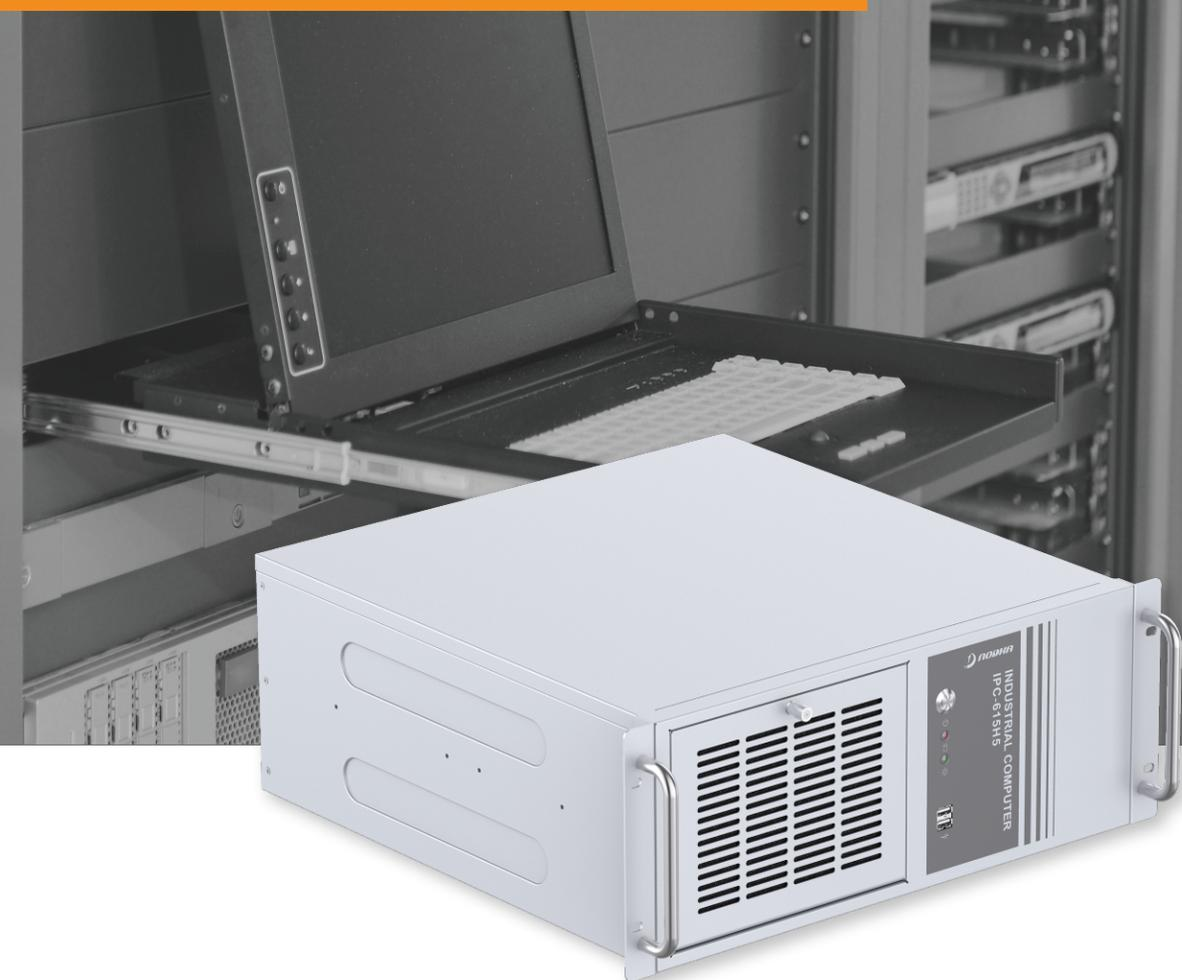
IPC-615H5基于高性能的Intel® Core™ i3/i5/i7/i9和Pentium®、Celeron® 台式机处理器，标准19"4U上架式工业机箱采用高强度镀锌板设计，内部散热风道采用正气压设计，为主板提供充分的扩展空间和高效的散热设备，前后面板接口丰富，扩展能力强悍，拥有 7 槽 PCIe/PCI 扩展卡槽，能最多可支持 4 个 3.5 寸硬盘 (SATA 接口)，拥有全面的安全设备 (TPM、加密狗)，可充分满足需要大量接入设备或需要大量计算单元的工业应用场景需求。
