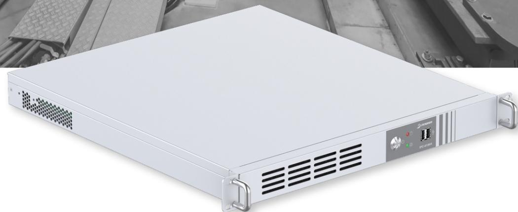
IPC-615H1是一款标准的19英寸1U上架式机箱,符合行业标准,方便集成到各种工业环境中。它基于高性能的Intel® Core™ i3/i5/i7/i9和Pentium®、Celeron®台式机处理器。后面板配备远程开关端子,方便客户远程开关设备,丰富的IO接口满足不同的应用场景。
